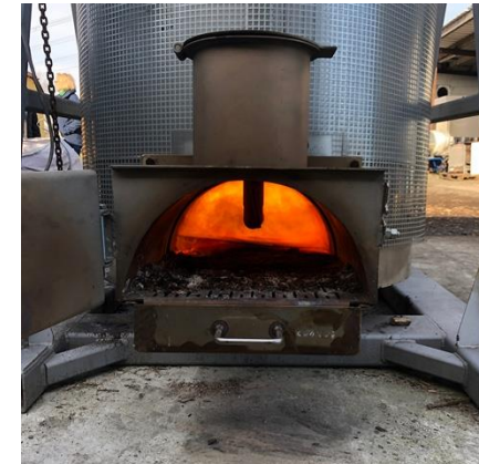
Abb. 49: Mobile Pyrolyse-Lösungen für landwirtschaftliche Betriebe zur Herstellung von Pflanzenkohle für den Eigenbedarf sind noch zu optimieren, Anke Hahn
