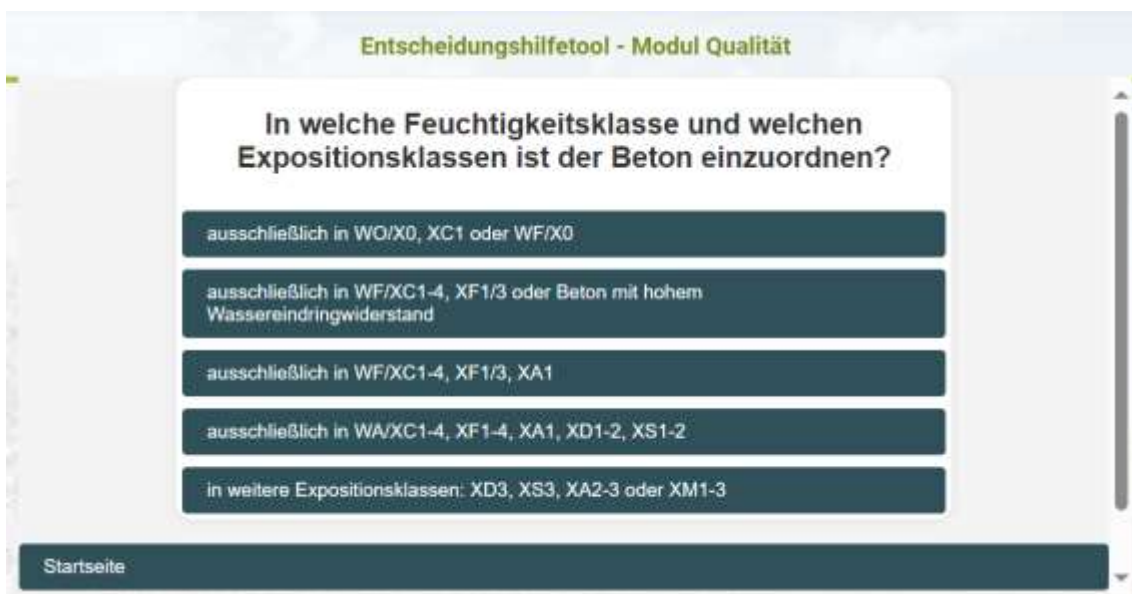
Abbildung 4: Beispielpfad des Moduls Qualität – Feuchtigkeitsklasse und Expositionsklassen
