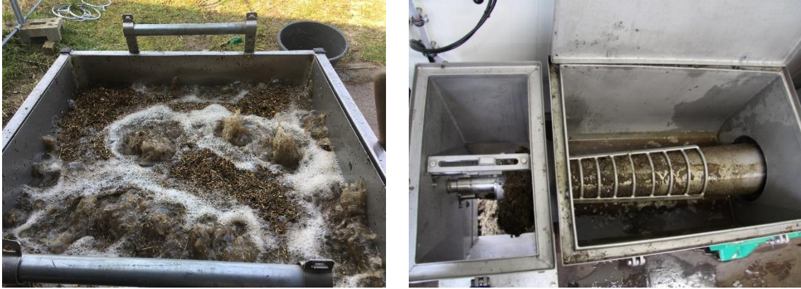
Abbildung 3 & 4: Hydrothermale Konditionierung (links) und mechanische Entwässerung (rechts) von Restbiomassen im IFBB-Technikkonzept im Labormaßstab
