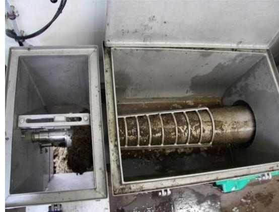
**Abbildung 4:** mechanische Entwässerung von Restbiomassen im IFBB-Technikkonzept
